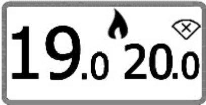
Tale icona, se osservata raramente, non costituisce un problema funzionale per il dispositivo. La causa più probabile è il sistema di risparmio energia che tende a smorzare la potenza del segnale radio. In completa autonomia il Termostato Campini aumenterà l'intensità del segnale radio per ristabilire la trasmissione radio.
